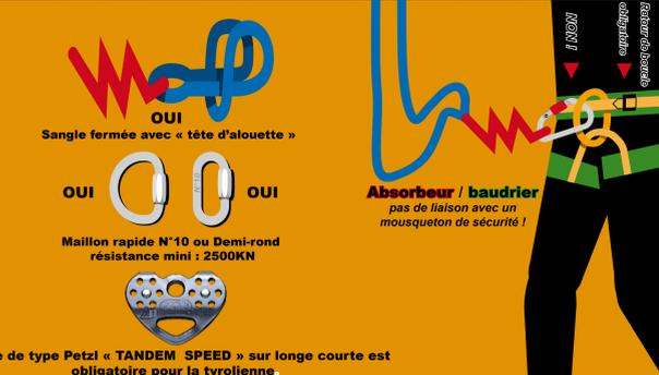
Absorbeur / baudrier pas de liaison avec un mousqueton de sécurité !
